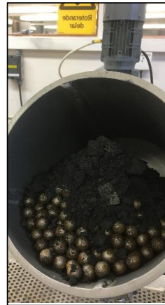
Processvatten efter sekundärmalning
